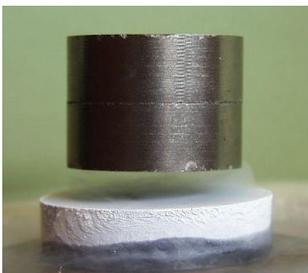
Un cylindre en **supraconducteur** (matériau aux propriétés magnétiques et électriques particulières) lévite sans contact au-dessus d'un aimant. Une bobine dans laquelle circule un courant électrique met en rotation le cylindre qui est placé dans le vide. On arrête la circulation du courant mais la rotation du cylindre continue toujours à la même vitesse, on a ainsi stocké l'énergie électrique sous la forme d'énergie cinétique (ici de rotation).
